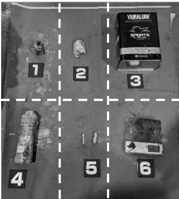
写真 1-6. 調査で確認された火災の危険性があるごみ
