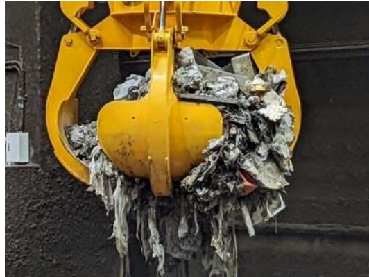
写真3. クレーンによる採取作業（拡大）
