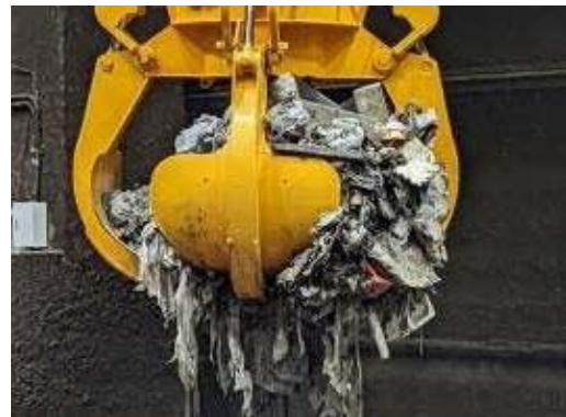
写真1-3. クレーンによる採取作業 (拡大)
