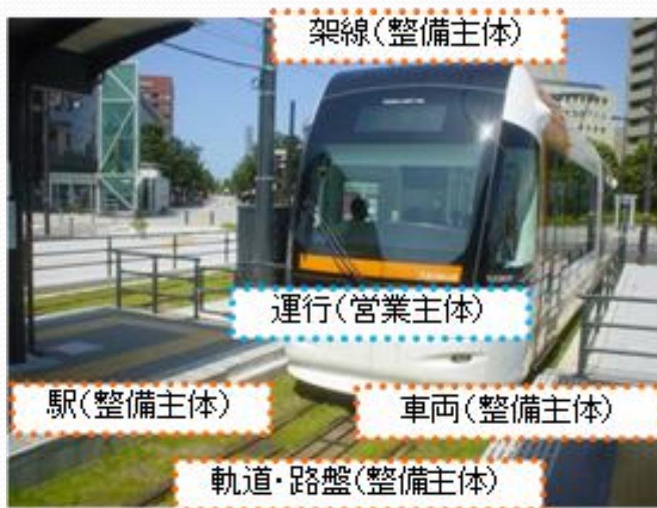
図: 上下分離方式の一般的な役割
