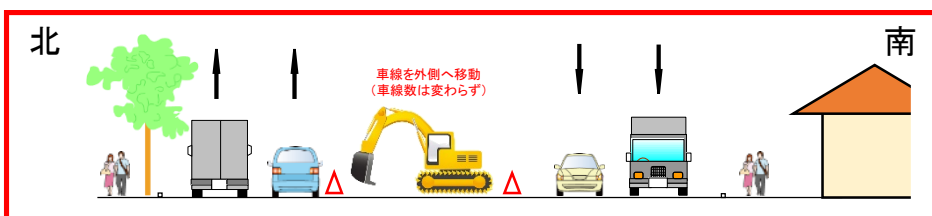
(2) 中央分離帯の撤去
